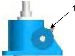
Garnir le graisseur (1) du carter d'engrenage à l'aide d'une pompe à graisse.
