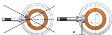
1. Tourner la roue hélicoïdale (vis sans fin) jusqu'à ce que la came d'impulsion soit visible dans le filet de fixation du générateur d'impulsions.
