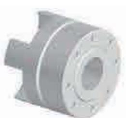
Moyeu réalisé avec bague de serrage. Ce modèle convient aux vitesses et couples élevés. Fixation par vis du côté croisillon. Le couple transmissible dépend du diamètre de l'alésage.
