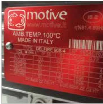
“DELFIRES” est une gamme innovante des moteurs triphasés, spécialement conçu pour fonctionner en ambiance jusqu'à 100°C en service continu S1. Particulièrement adapté pour les applications comme la déshydratation alimentaire, la ventilation de four
