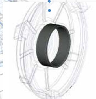
À partir du type 90, le siège des roulements a été renforcé avec un insert en acier, noyée dans chaque palier en aluminium moulé sous pression.
