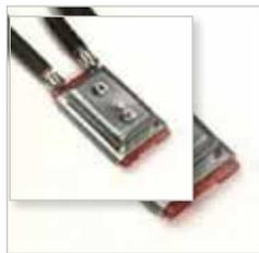
Il s'agit d'un dispositif électromécanique, normalement fermé, qui s'ouvre électriquement lorsque la température atteint le niveau de déclenchement; il retourne dans sa position normale, dès que la tem-
