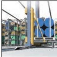
Système de mesure magnétique à forte tolérance avec un écart capteur/bande de 20 mm max. convenant parfaitement aux travaux d'extérieur (travail de la pierre).
