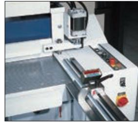
La bande magnétique sert de référence du système de mesure. La structure souple de la bande se prête aussi à un montage en courbe sur de petits rayons pour une mesure angulaire aisée
